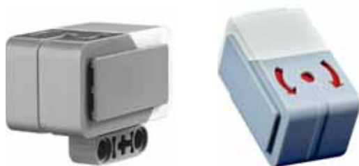
47-сурет. Гироскопиялық датчик
