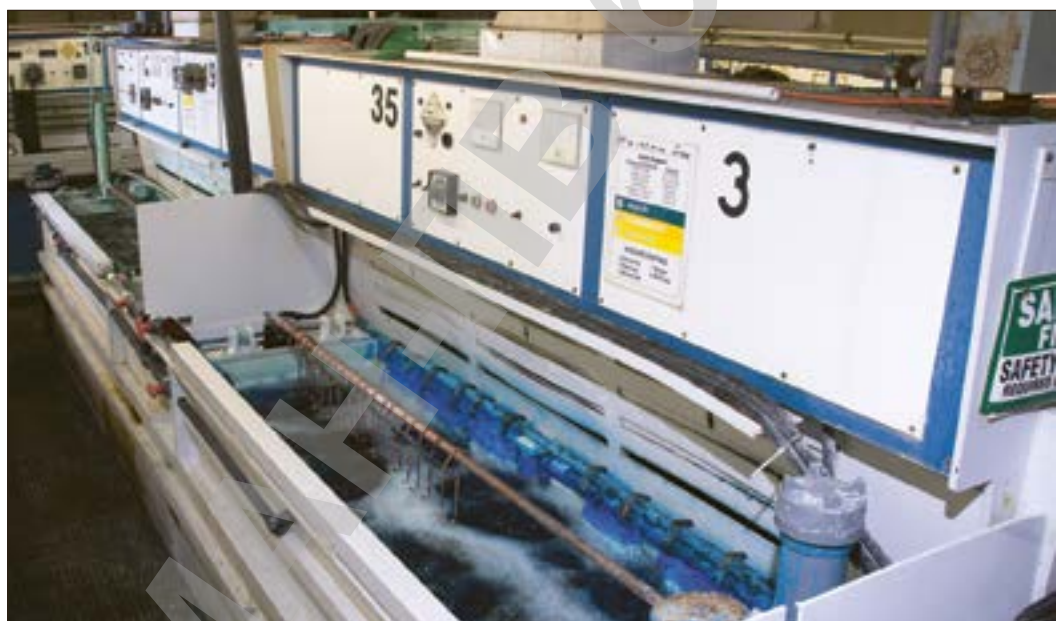
166-сурет. Өнімді мыспен қаптауға арналған ванналар
