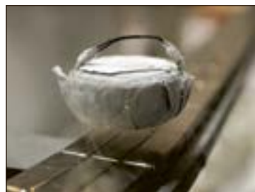
188-сурет. Асқынөткізгіштің тұрақты магниттен жасалған рельстермен әрекеттесуі
