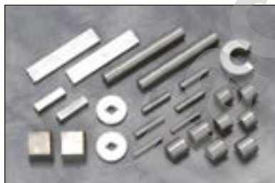
230-сурет. «Альнико» қорытпасынан жасалған магниттер
