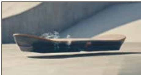
189-сурет. Магниттік левитация құбылысына негізделген ховерборд, 2005 ж.
