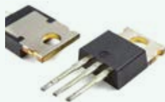
183-сурет. Кремний-биполярлы транзистор
