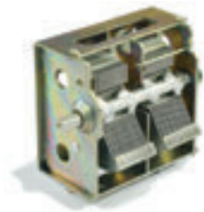
188-сүрәт. Өзгәрмә сиғдуршлиғи бар конденсатор
