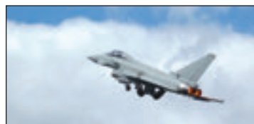
91-сүрәт. Жуқури тавушлуқ илдамлиқтики самолетларниң алдинқи бөлигигә қоршап еқишқа оңай шәкил берилгән
