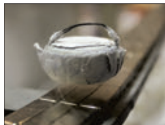
227-сүрәт. Адэттин ташкири өткүзгүчниң турақлик магниттин ясалған рельслар билән тәсирлишиши
