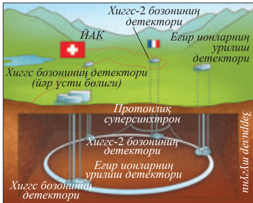
288-сүрәт. Йоган андронлуқ коллайдер әсвапиниң принциплик схемиси (ЙАК)
