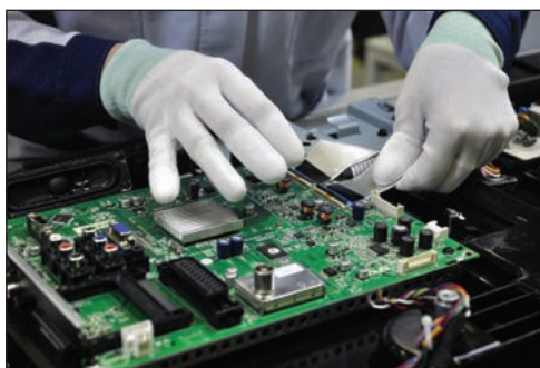
25-сурет. Теледидар құрастыру және баспалық тақша жасау желілері
