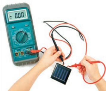
36-сурет. Мультиметр арқылы тұрақты ток көзінің ЭҚК-сын өлшеу
