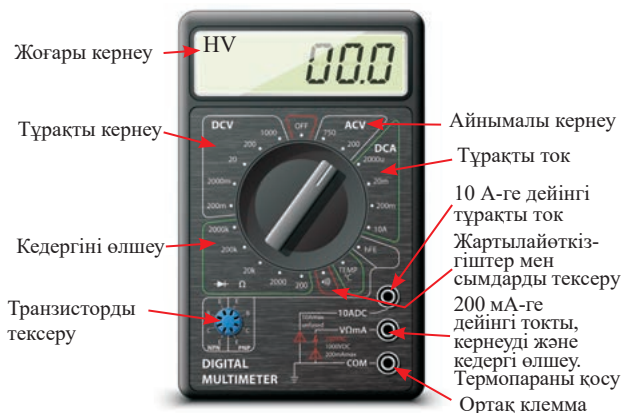
35-сурет. Жұмыс тәртіптері көрсетілген мультиметр панелі
