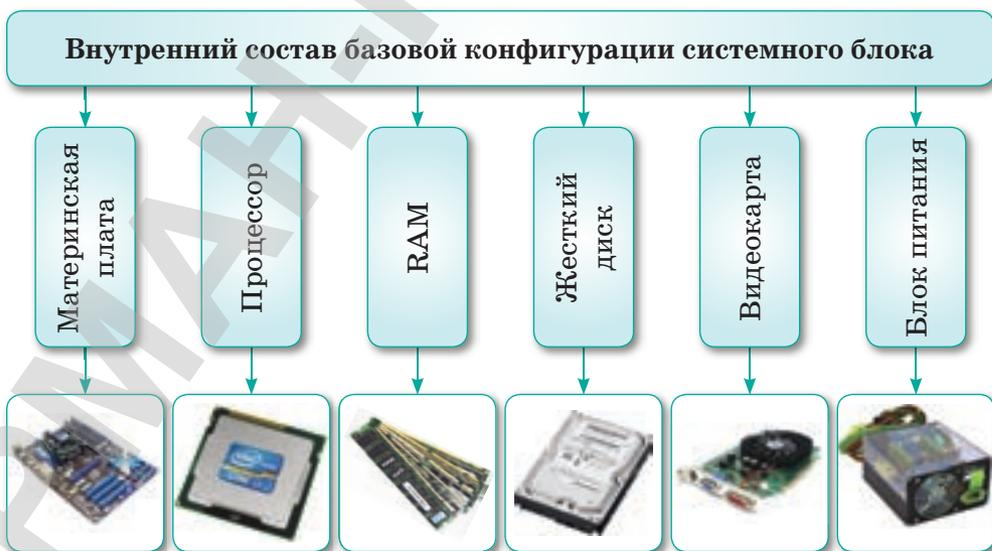
Схема 4. Внутренний состав системного блока
