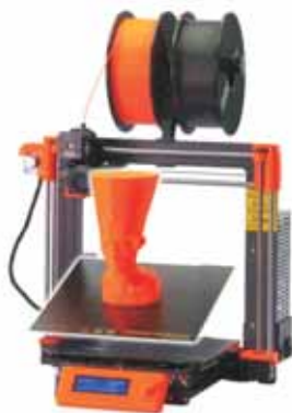
Рис. 29. 3D-принтер марки Prusa I3 MK3
