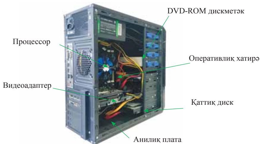
8-сүрәт. Компьютерниң системалиқ блогиниң ички түзүлүши
