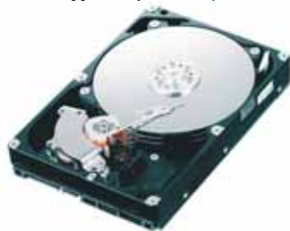
11-сүрәт. Қаттиқ дискниң ички түзүлүши
