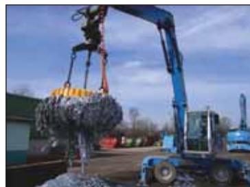
154-сурет. Магнитті көтергіш кран
