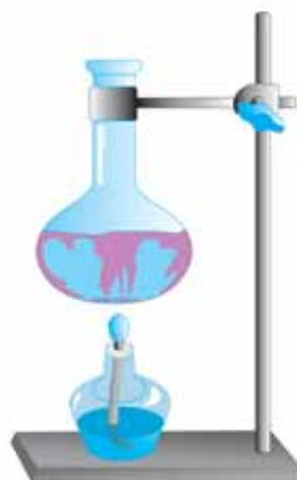
12-сурет. Конвекциялық ағынның қозғалысы
