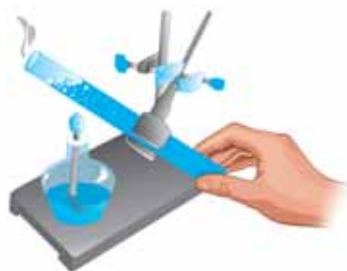
10-сурет. Сұйықтың жылуөткізгіштігі нашар
