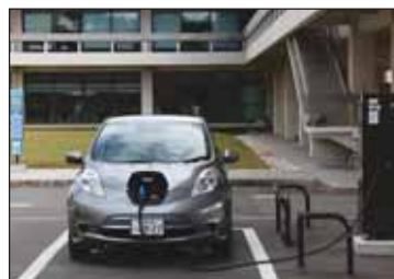
67-сурет. Nissan Leaf 2016 электр көлігі кернеулігі 220 В болатын ток көзінен қуаттанады
