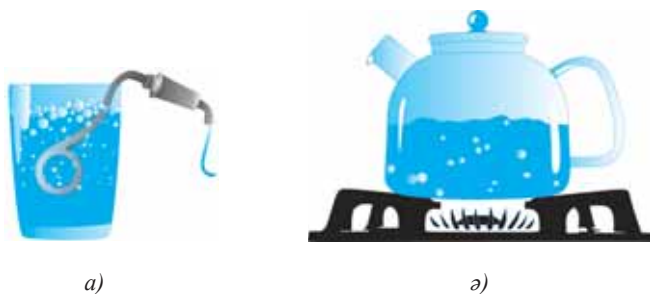
13-сурет. Конвекциялық ағындар арқылы сұйықтың қызуы
