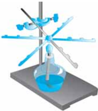
9-сурет. Металдардың жылуөткізгіштігі әртүрлі
