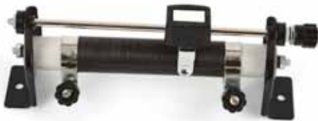
107-сурет. Зертханалық реостат
