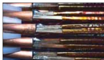
123-сурет. CERN зертханаларында жасалған асқынөткізгішті кабельдер
