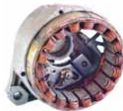
172-сурет. Зәкір – генератордың сыртқы орамасы
