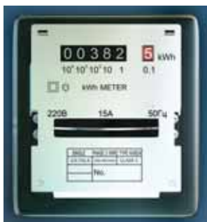
120-сурет. 1 ай интервалындағы электресептеуіш аспаптың көрсеткіші
