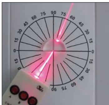
96-сурет. Оптикалық диск арқылы шынының сыну көрсеткішін анықтау
