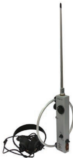
70-сурет. Диапазоны 3,5 МГц радиопеленгатор
