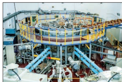
155-сурет. Қазақстандық Материалтану Токамағы
